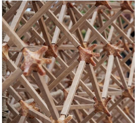
耐水加工した、パスタでできたジョイントとリサイクルペーパー管。耐水化に用いる超越液は土に還ります。
