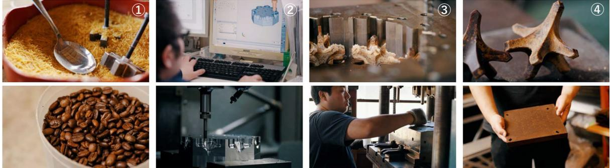
パーツ制作工程。①今回用いた食品廃棄物の一例。②パーツの金型制作。③廃棄物の粉末を金型に詰め、加熱しながら圧縮を施す。④完成したパーツ（写真はパスタからなるジョイント [上]、コーヒーかすからなる床材 [下]）。ここに耐水加工を行う。
