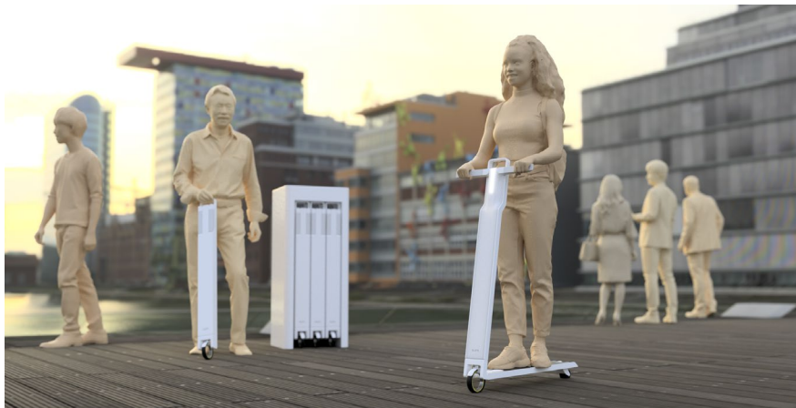
コンセプトデザイン。車体とハンドルを畳み、後輪をしまい込むことで薄板状に。
